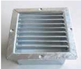
Bodenlüfter aus verzinktem Stahl werden durch ihre Bauart versenkt montiert. Mit der Belüftungsfläche von min. 100 cm<sup>2</sup> können sie in Kombination mit Seitenwand- oder Dachlüfter für den Transport von Gasflaschen eingesetzt werden.
