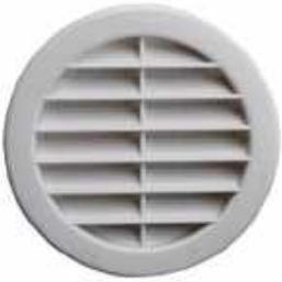
Wenn eine Erhöhung des Fahrzeugs unerwünscht ist, sind Seitenwandlüfter mit Insektenschutz bei einem Durchmesser von ca. 125 mm die Alternative. Sie sind dauerhaft geöffnet und haben auf der Laderaumseite einen Durchschlagschutz.
