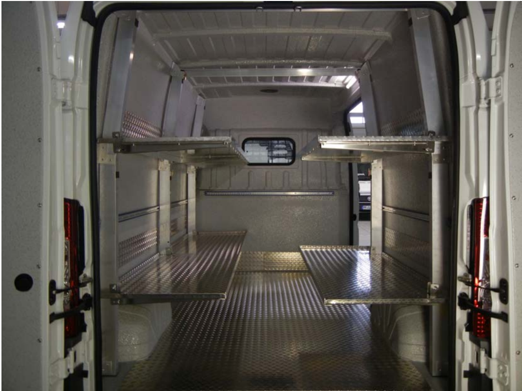
Klappregale erhöhen die Ladekapazität nicht stapelbarer Ware
